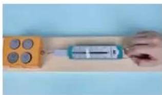
图 3.2-4 测量静摩擦力的实验装置
