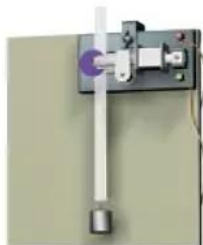
图 2.4-2 自由落体运动的实验装置
